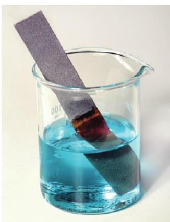
**Fig. 2.** Une plaque de fer plongée dans une solution de sulfate de cuivre (II)
